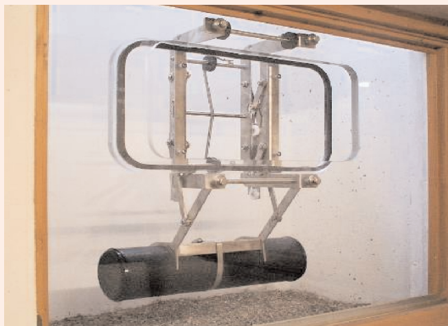
Automatisches Hochwasserschutzfenster mit Schwimmersteuerung
